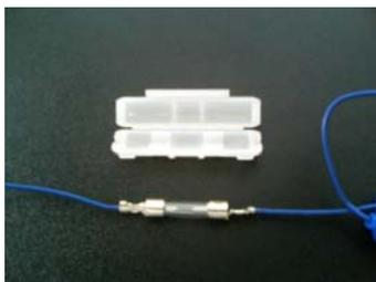
「ミニヒューズコネクタ」を「ガラス管ヒューズ」に付けます。接続した「ミニヒューズ」を、「ヒューズホルダー」にしまい、閉じます。「ミニヒューズ」を車のヒューズボックス内の常時通電箇所に差し込んでください。
