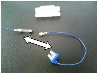
両手で「ヒューズコネクタ」から「ガラス管ヒューズ」を外します。金具の部分をヨコに引っ張ってはずします。
